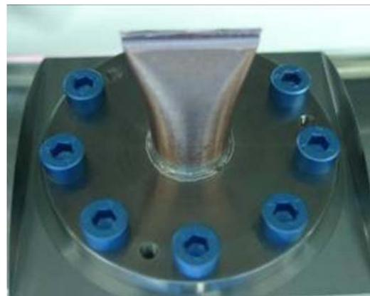
**Fig. 6 : Copper pinch-off tube**
